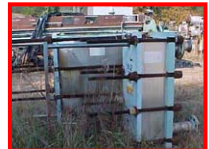
71368 Alfa Laval, P31EH, CS, 304, 279 pies 2 , Placas de Acero Inoxidable, 225 psi, 325°F
