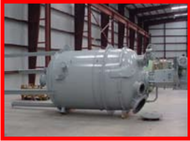
84344 Astrocosmos, 2000 gal., Zirconium Clad, 6'6" x 7'2", 50 psi, Agitación
