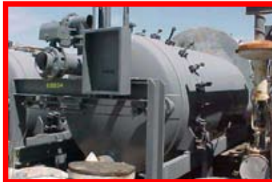
68834 Duriron, 72-HC-1512, Pressure Leaf, 1500 pies 2 , Coraza y platos internos de Acero Inoxidable 316L
