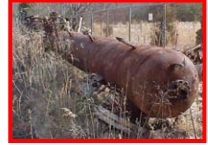
20883 F.W. Glitsch, CS, 4'0" x 86'3" y 2'6" x 28'6", 250 psi, Tipo platos
