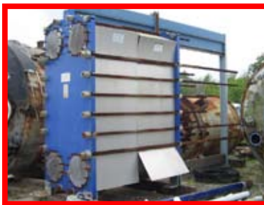
92888 Alfa Laval, M30-FG, 9269 pies 2 , sin usar, Placas de Acero Inoxidable, 150/150 psi, 200/200°F
