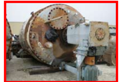
89342 Vulcan, 6200 gal., S. Nickel Clad, 8'9" x 12'3", 35 psi, Chaqueta, Agitación
