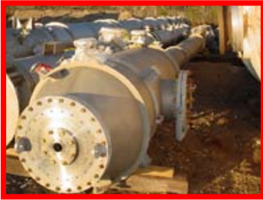
87898 Koch, 304LSS, 3'4" x 7'0", 1'8" x 31' 10" y 40" x 7', sin usar, 150 psi, Tipo empacado
