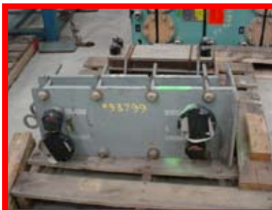
93799 ALFA LAVAL, Marco CS, Placas Titanio, 25 pies 2 , tipo P-2
