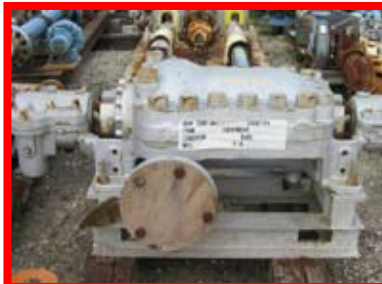
88504 I/R, 5H14TA-4, 850 GPM, 8" X 6", 1600 ft head, Acero al carbón
