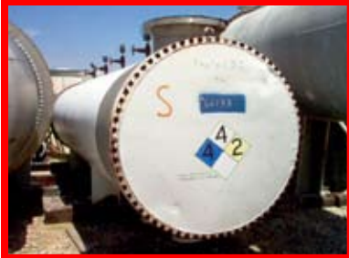
66133 Slagle, 14736 pies 2 , CS/304SS/ 304LSS, 75/75 psi, 325/325°F, Tipo NEN
