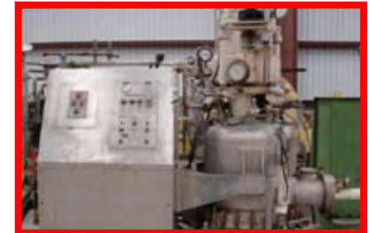
93867 Cogeim, 2 pies 2 , NUTSCHE filtro/secador, Hastelloy C y Acero Inoxidable 316, Jacketed 87 psi
