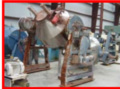
89971 Gemco, Liquid/Solid, Doble Cone, 40 pies 3
