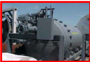
68833 Duriron, 72-HC-1512, Pressure Leaf, 1500 pies 2 , Coraza y platos internos de Acero Inoxidable 316L
