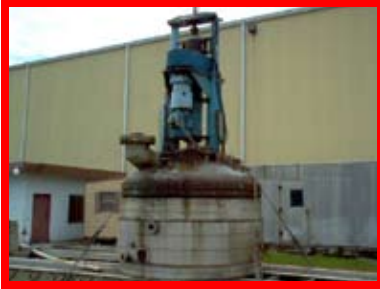
85915 Rosenmund, Nutsche, 43.04 pies 2 , filtro/secador, Acero Inoxidable 316, 50 psi, Jacket 150 psi
