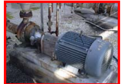
90207 Durco, 200 GPM, 4"x3"x10", 50 HP, Acero Inoxidable 316
